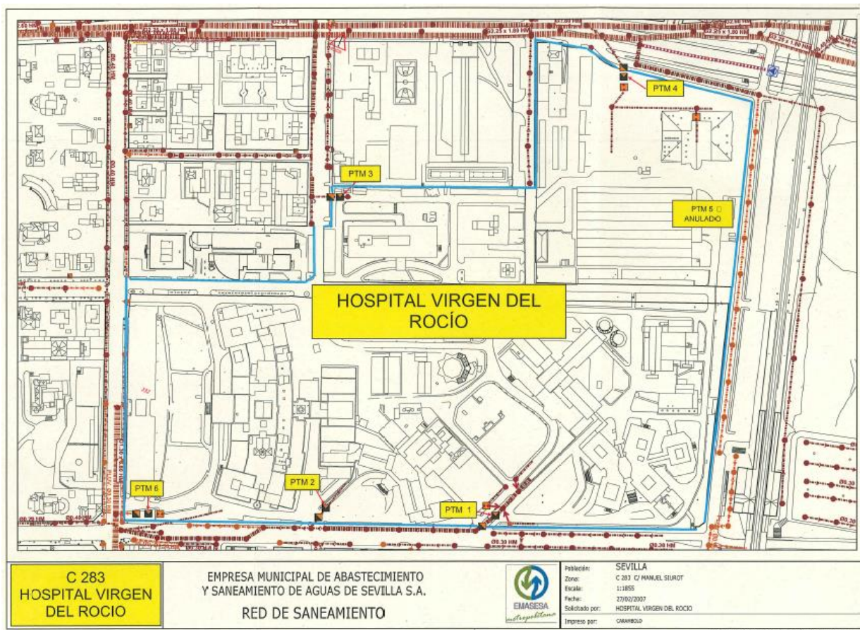
Plano ubicación de los Puntos de Toma de Muestra (PTM) del HUVR.
